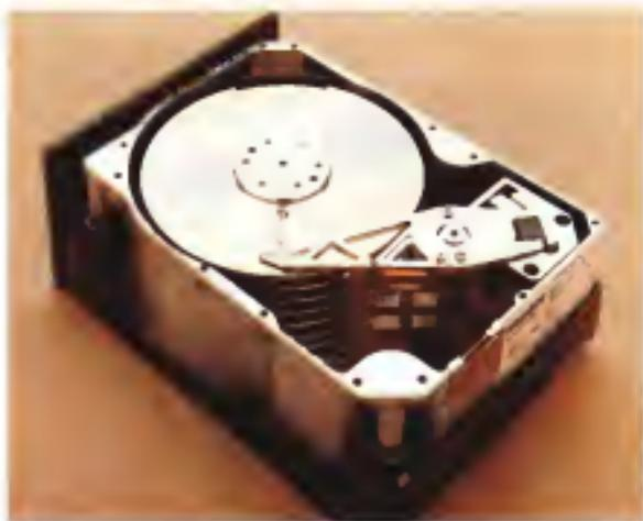
In questa speciale si può notare l'eccellente costruzione attuativa dei drive (il sistema di registrazione del drive)
